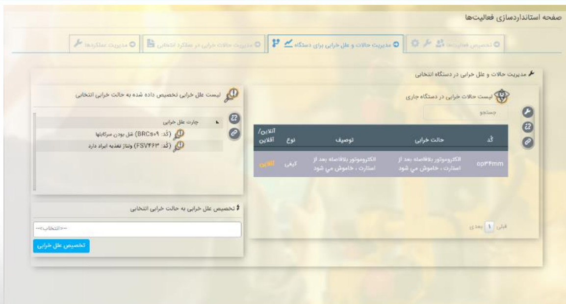
شکل (۷-۱) تعریف و تخصیص علل خرابی به حالت های خرابی دستگاه
